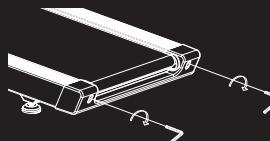
제품을 오래 사용하면 러닝 벨트가 느슨해질 수 있습니다. 벨트를 단단하게 조이려면 왼쪽과 오른쪽의 사이드 볼트를 시계 방향으로 한 바퀴 돌린 후 벨트의 조임 상태를 확인합니다. 벨트의 조임 상태가 적절해질 때까지 이 과정을 이어갑니다. 반드시 양쪽을 동일하게 조절해야 벨트의 문제를 해결할 수 있습니다.
