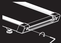
SILA CINTA DE CORRER SE DESPLAZA A LA IZQUIERDA: GIRE LOS PERNOS DEL LADO IZQUIERDO  $\frac{1}{4}$  DE VUELTA EN SENTIDO HORARIO, A CONTINUACIÓN GIRE EL PERNO DERECHO  $\frac{1}{4}$  DE VUELTA EN SENTIDO ANTIHORARIO. SILA CINTA NO SE DESPLAZA, REPETIR HASTA CENTRARLA.
