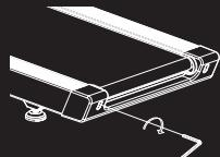
SI LE TAPIS ROULANT SE DÉPLACE VERS LA GAUCHE : TOURNER LES BOULONS DE GAUCHE D'UN QUART DE TOUR DANS LE SENS DES AIGUILLES D'UNE MONTRE, PUIS TOURNER LE BOULON DE DROITE D'UN QUART DE TOUR DANS LE SENS INVERSE DES AIGUILLES D'UNE MONTRE. SI LE TAPIS NE BOUGE PAS, RÉPÉTER L'OPÉRATION JUSQU'À CE QU'IL SOIT CENTRÉ.
