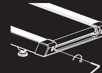
WENN SICH DAS LAUFBAND RECHTSHERUM BEWEGT: DREHEN SIE DIE SCHRAUBE AUF DER RECHTEN SEITE UM 90 GRAD IM UHRZEIGERSINN UND DANN DIE SCHRAUBE AUF DER LINKEN SEITE UM 90 GRAD GEGEN DEN UHRZEIGERSINN. BEWEGT SICH DAS LAUFBAND NICHT, WIEDERHOLEN SIE DEN VORHERIGEN SCHRITT, BIS ES SICH ZENTRIERT.
